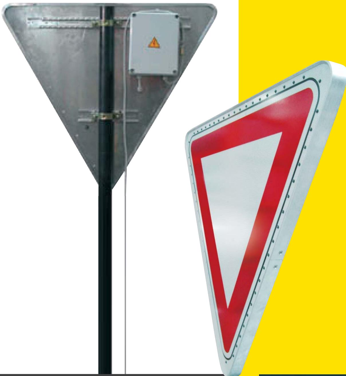
Segnale in alluminio assemblato a cassetto con inserito nei bordi LED disponibili nei colori bianchi, ambra o rossi. Si possono alimentare sia con corrente a 220 V o con pannelli solari, sono disponibili con funzionamento notturno o tutto il giorno. Funzionamento a cascata per i delineatori di curva, per le strade ghiacciate con sensore di temperatura e per segnalare il vento alle uscite delle gallerie con sensore anemometro.
